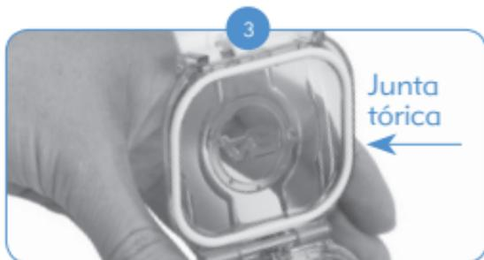
Antes de colocar el Naída CI en el AquaCase, compruebe visualmente que la junta tórica esté correctamente fijada. **Compruebe visualmente que la junta tórica no está seca, rota ni sucia. De ser así, sustitúyala antes de utilizarla.**
