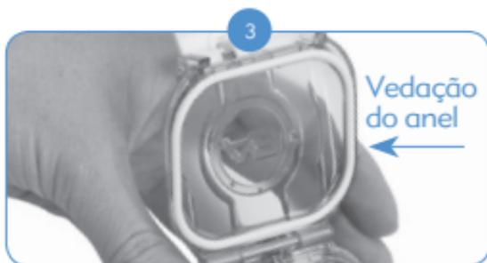
Antes de colocar o Naída CI no AquaCase, inspecione visualmente a vedação do Anel para se certificar de que ele esteja encaixado corretamente. **Confirme visualmente se o Anel não está seco, quebradiço ou sujo. Se for este o caso, substitua o Anel antes de usá-lo.**
