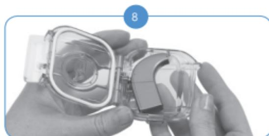
Das Naída CI sollte dicht an der Rückwand des AquaCase sitzen und flach an der Bodenoberfläche anliegen.
