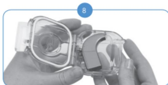
O Naída CI deve se encaixar firmemente na parede traseira do AquaCase e permanecer em contato com a superfície inferior.
