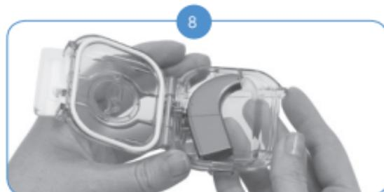
El Naída CI debe ajustarse firmemente en la pared posterior del AquaCase de modo que descansa horizontalmente con respecto a la superficie inferior.
