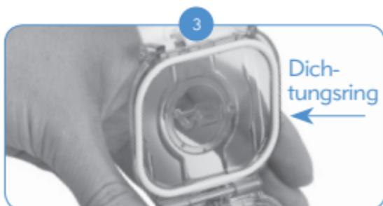
Überprüfen Sie den korrekten Sitz des Dichtungsring, bevor Sie das Naída CI in das AquaCase einsetzen. Stellen Sie sicher, dass der Dichtungsring nicht ausgetrocknet, brüchig oder schmutzig ist. Sollte eine dieser Eigenschaften zutreffen, tauschen Sie den Dichtungsring aus.
