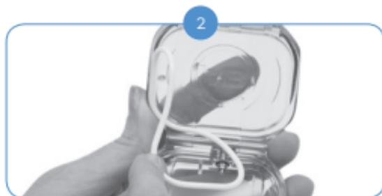
Sobald der Dichtungsring an einer Stelle herausragt, können Sie ihn greifen und vollständig aus der Nut herausziehen.
